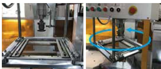
旋回ガイドヘッド採用で入れ子にも対応可能
