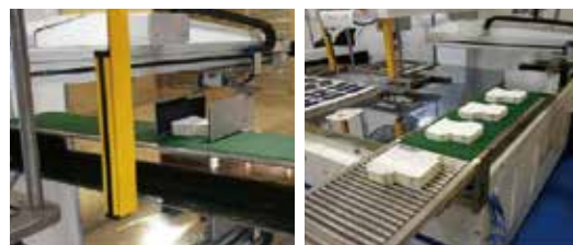
アームによる自動搬出装置、オプションにて搬出方向等自由設計
